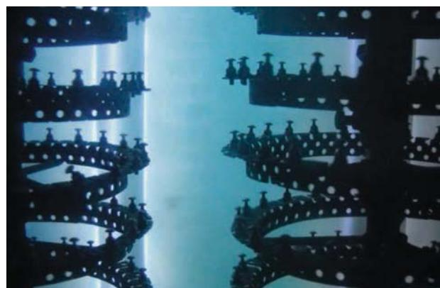
Установки RTAS оснащены круговыми дуговыми и цилиндрическими распылительными источниками. Многократные комбинации распыления постоянным током, распыления МП, дуговым испарением и источниками ионов и т.д.
